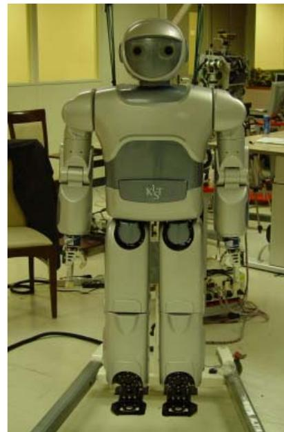
Fig. 1. Humanoid robot MAHRU-R
